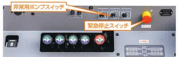
車両後端操作部
